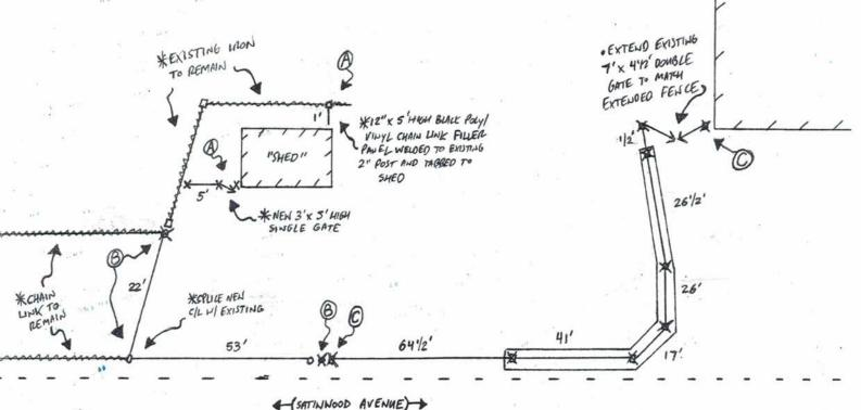
C EXTEND EXISTING 1765 POSTS AND INSTALL 1751/2 OF NEW 2' HIGH ME-GILV. BLACK MEANY REGAL 1864 FENCE ON TOP OF EXISTING 44"-56" INON FENCE RUS EXTEND (1) EXISTING 7'X (4"/2") DOUGLE GATE TO MATCH HEIGHT OF EXISTING (EXTENDED) HEAVY REGAL IRON FENCE
